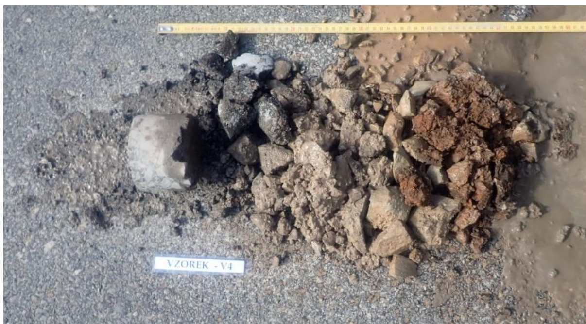
Obr. 7 - Jádro vývrtu Vzorek – V4 (in situ).
